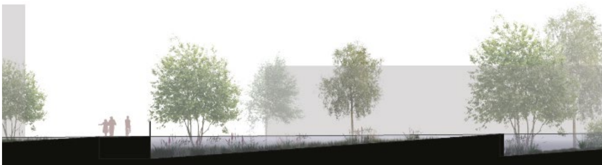
Längdsektion som visar princip på skyfallstråk med sektioner för hantering av skyfallsvatten med varierad vegetation och lutning väster ut.
