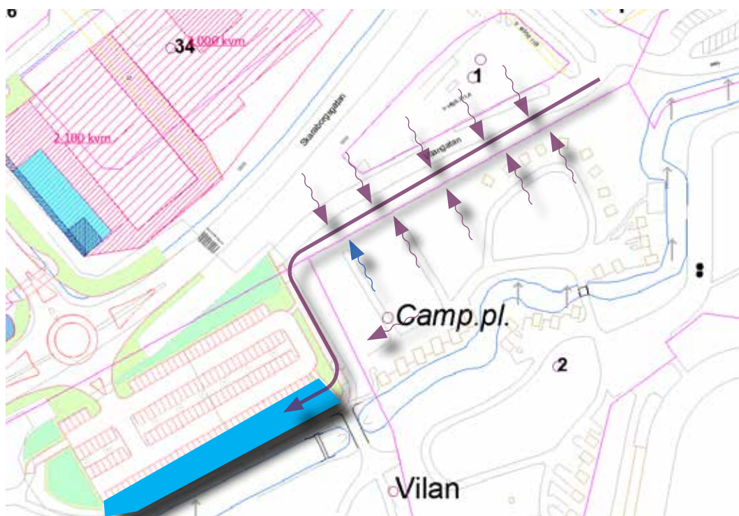
Schematisk figur över möjlig dagvattenhanteringsanläggning. Blå yta visar möjligt läge för öppen dagvattenhantering inom allmän plats. Lila linje hur avrinning säkerställs.
