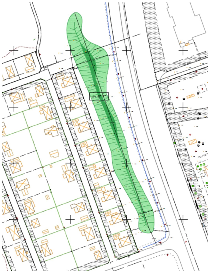
Illustration över bullervall längs väg 184 som är under byggnation.
