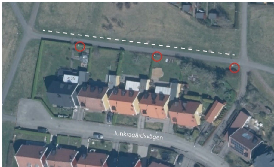
Bild 18 visar belysningsstolparnas nuvarande placering inom trädgårdsmark. Ny placering föreslås ske norr om GC-vägen markerat med vit streckad linje.
