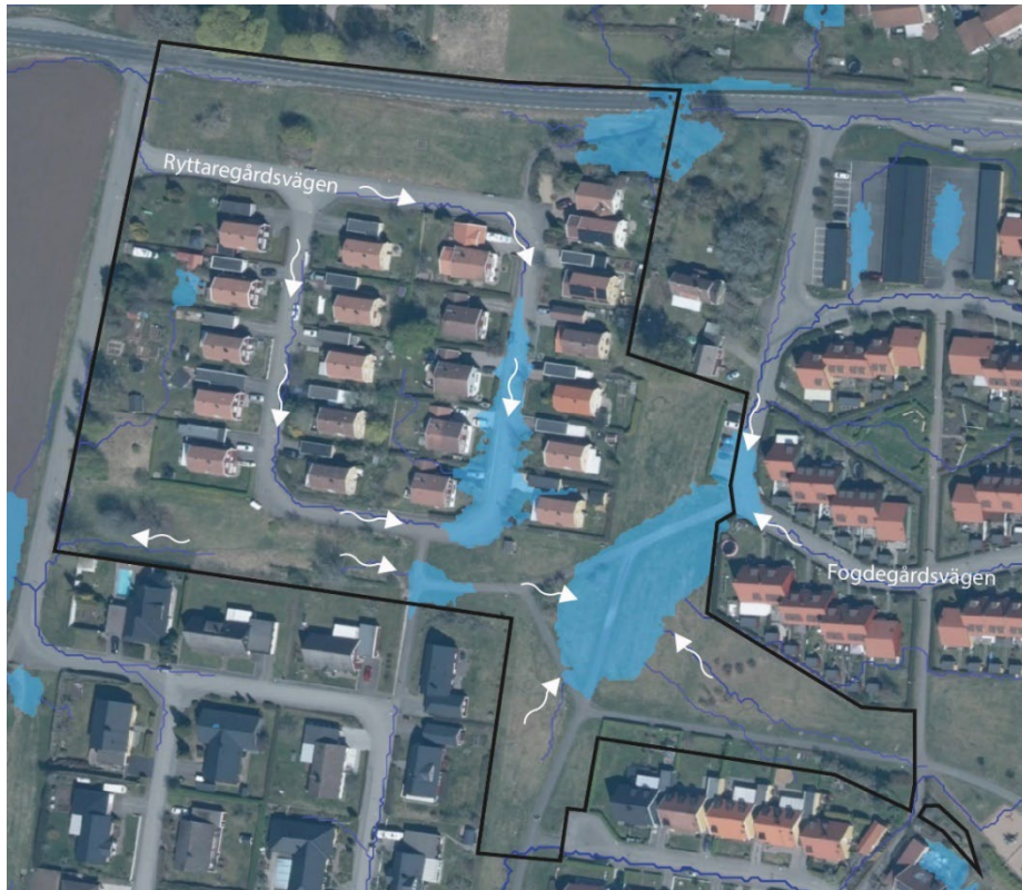
Bild 10 visar översvämningssituationen och vattnets rinnriktning i området med hjälp av programvaran Scalgo Live. Bilden tar inte hänsyn till befintligt ledningsnät eller eventuella infiltrationsmöjligheter, men ger en uppfattning om vart vatten samlas och varifrån det rinner.
