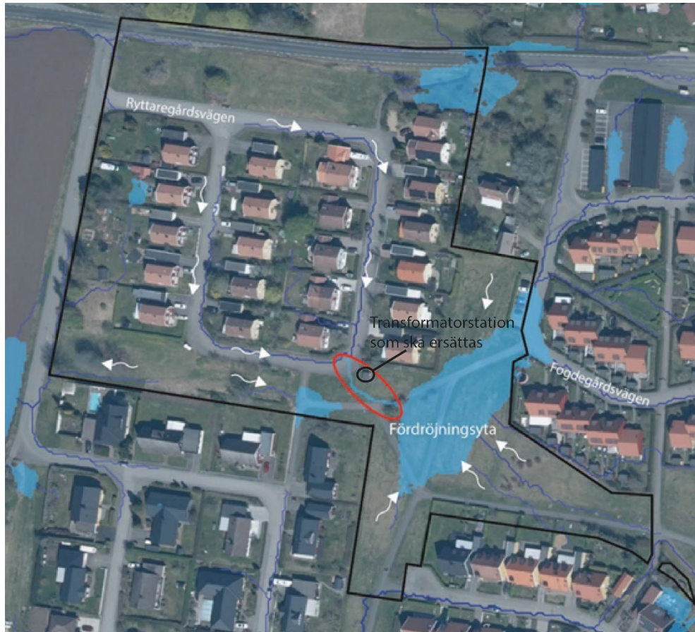
Bild 17 visar hur översvämningsrisken minskar på Ryttaregårdsvägen efter föreslagen åtgärd inom parkytan (markerat med röd cirkel) samt transformatorstationen som ska ersättas. Bilden är framtagen med hjälp av programvaran Scalgo Live.
