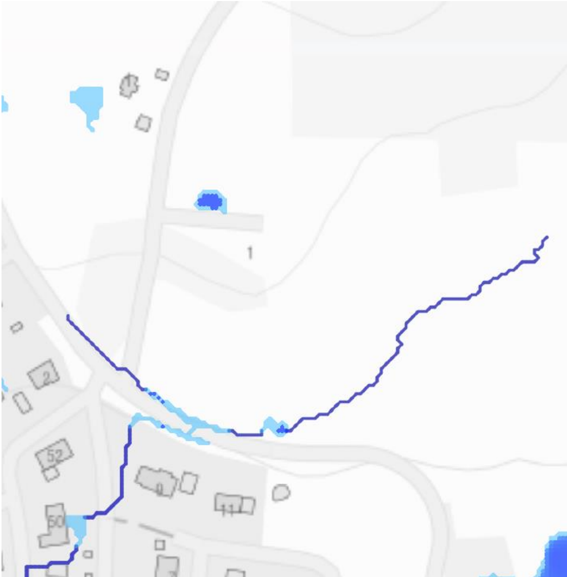
Figur 7. Utdrag från skyfallskarteringen som visar lågpunkt och rinnväg.
