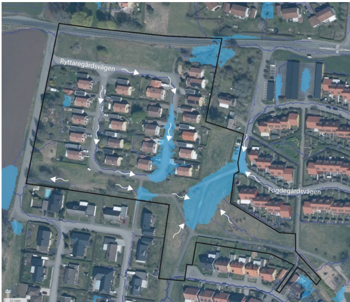
Figur 3 visar översvämningsrisken och vattnets rinnriktning med hjälp av Scalgo Live. Bilden tar inte hänsyn till befintligt ledningsnät eller eventuella infiltrationsmöjligheter, men ger en uppfattning om vart vatten samlas och varifrån det rinner.
