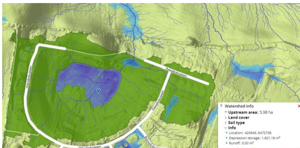
Figur 29. Ytvattnet på det grönmärkerade området infiltreras i dödisgropen vid ett 100-års regn (Scalco, 2021).
