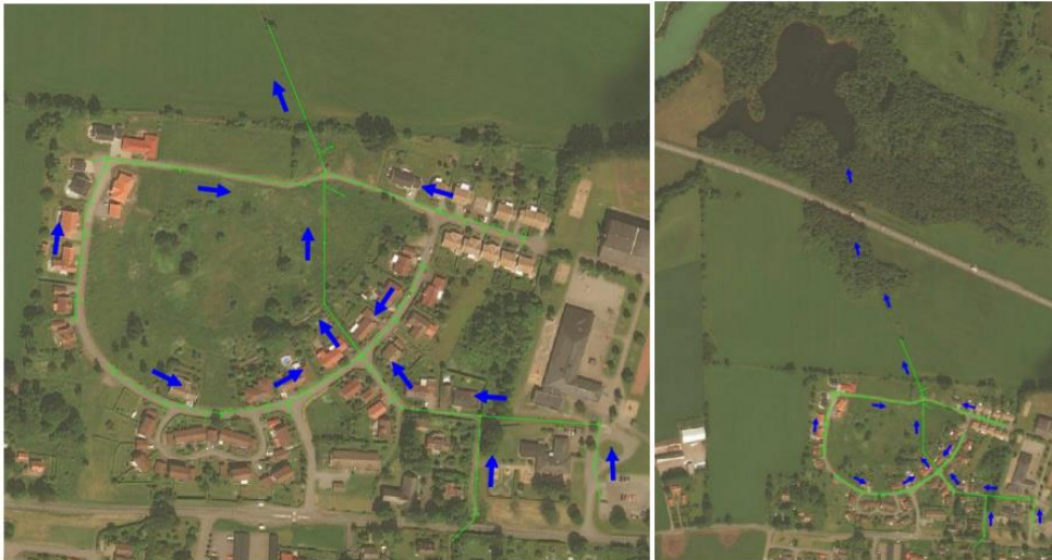
Figur 26. Befintlig avvattnings inom planområdet.
