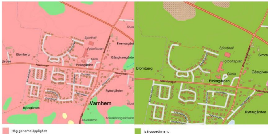
Figur 22. Enligt SGU:s karta för genomsläpplighet och jordarter så består marken inom området av isälvssediment med hög genomsläpplighet.
